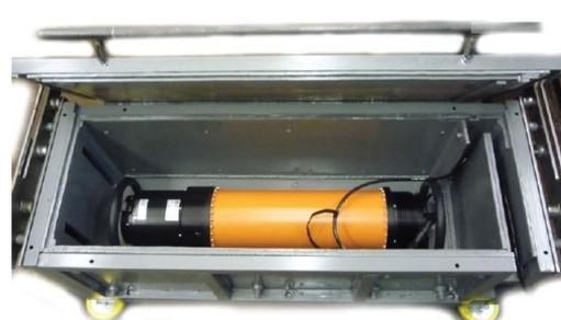
Разборные кабины серийно изготавливаются в типоразмерах 1200 x 400 x 400, 1200 x 1200 x 800, 1500 x 1000 x 1200, 2200 x 1800 x 2200, 2200 x 2200 x 2200 мм для работы с аппаратами постоянного потенциала с анодным напряжением 160, 225 и 300 кВ, а также с импульсными аппаратами.
