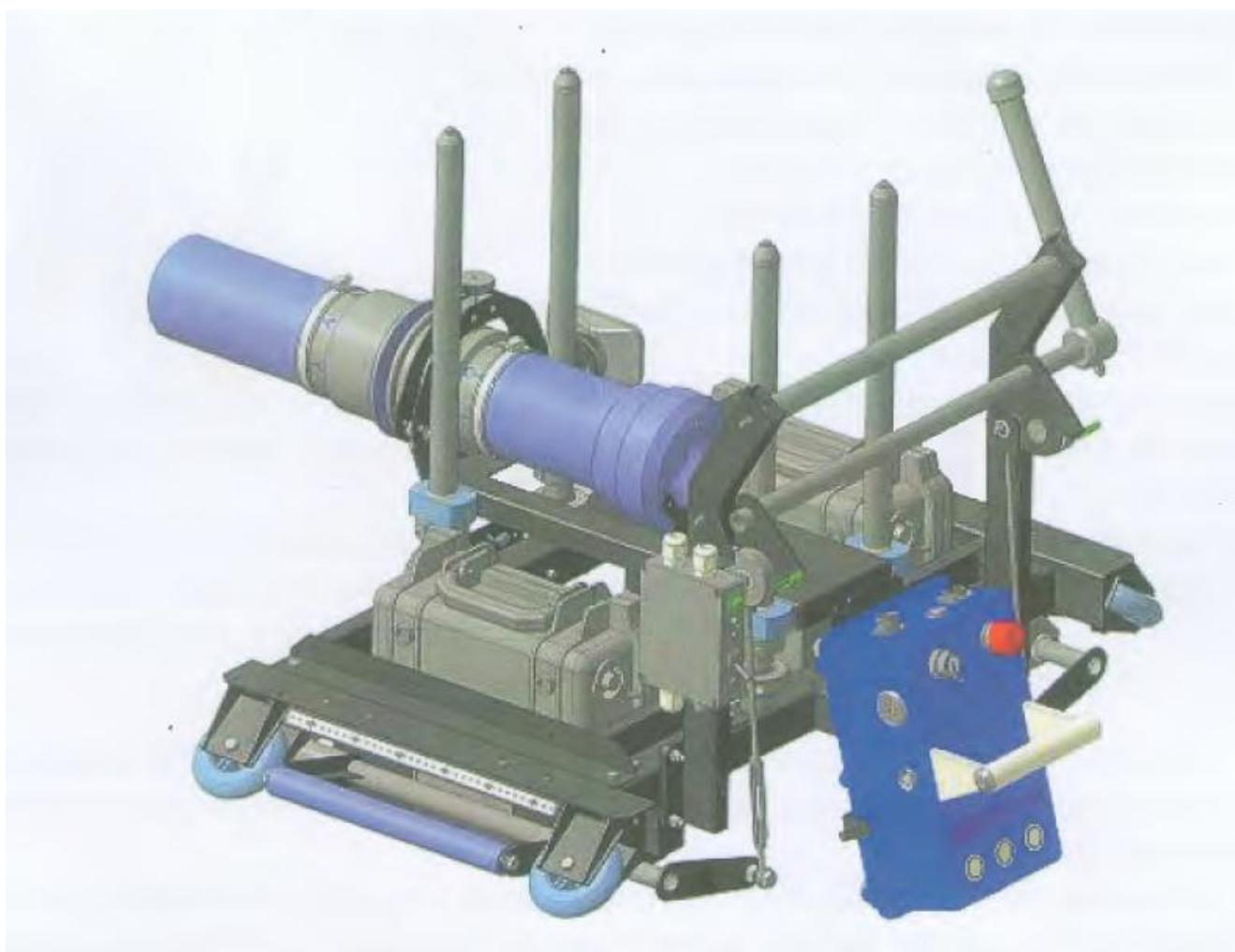
Тележка обеспечивает точную установку моноблока панорамного рентгеновского аппарата 0,3 СБК 200 СП РК по оси тестируемой трубы таким образом, что фокусное пятно аппарата оказывается в плоскости кругового сварного шва трубы.
